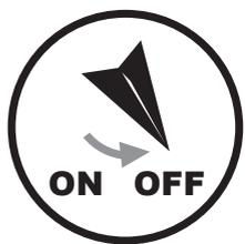
Feche sempre a alimentação de ar e desconecte a mangueira de alimentação de ar antes de instalar, remover, ajustar qualquer acessório nesta ferramenta, ou antes de executar qualquer serviço de manutenção nesta ferramenta.
